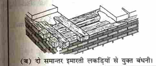
चित्र 5.9 (क) दीवारों में सरदल स्तर पर लकड़ी की भूकम्पीय पट्टिका
