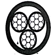
चित्र 2.5 : घृताकार लड़ीदार चालकों वाला एक लाक्षणिक तीन क्रोड की केबिल
