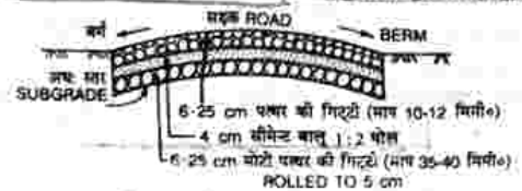
चित्र 6.12—सैंडविच मोर्टार मैकेडम पैवमेंट
